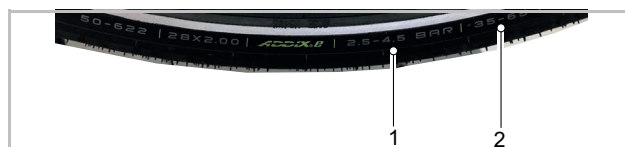
Abbildung 46: Angabe Fülldruck in bar (1) und psi (2)
