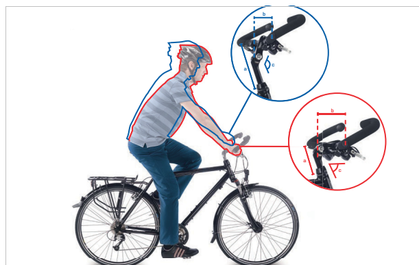
Abbildung 27: Citybike (blau) und Trekkingrad Position (rot) durch Winkeländerung
