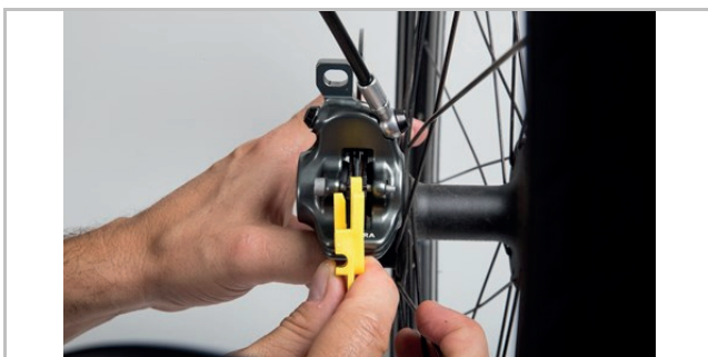
Abbildung 49: Bremsbelag im eingebauten Zustand mithilfe der Transportsicherung prüfen
