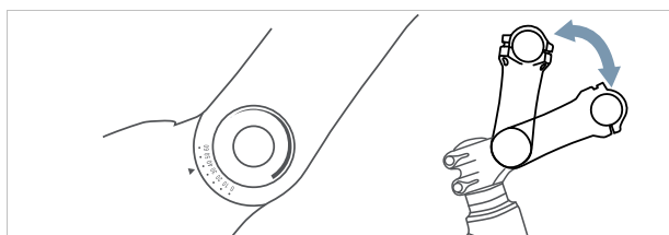
Abbildung 26: Unterschiedliche Versionen von winkelverstellbaren Vorbauten
