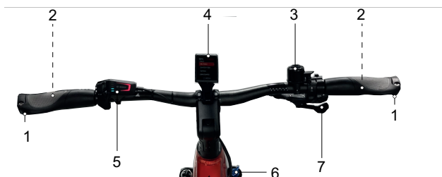
Abbildung 3: Lenker, Beispiel BOSCH LED Remote mit Kiox 300
