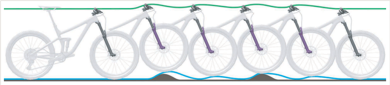
Abbildung 484: Zu schnelles Ausfedern der Federgabel
