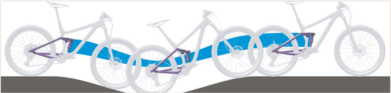
Abbildung 514: Zu weiche Federung des Hinterbau-Dämpfers am Berg
