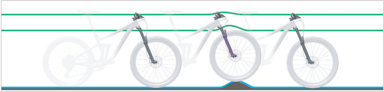
Abbildung 25: Optimales Fahrverhalten der Federgabel bei Unebenheiten
