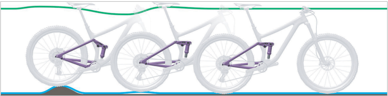
Abbildung 494: Zu schnelles Ausfedern des Hinterbau-Dämpfers
