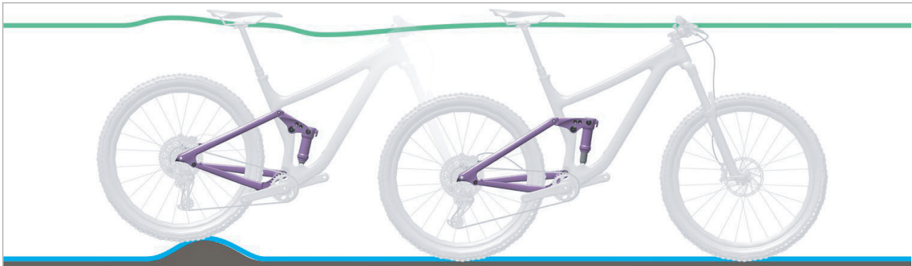
Abbildung 317: Optimales Fahrverhalten des Hinterbau-Dämpfers bei Unebenheiten
