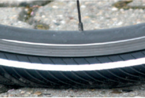
Abbildung 217: Korrekter Fülldruck. Der Reifen ist unter der Last des Körpergewichts kaum verformt
