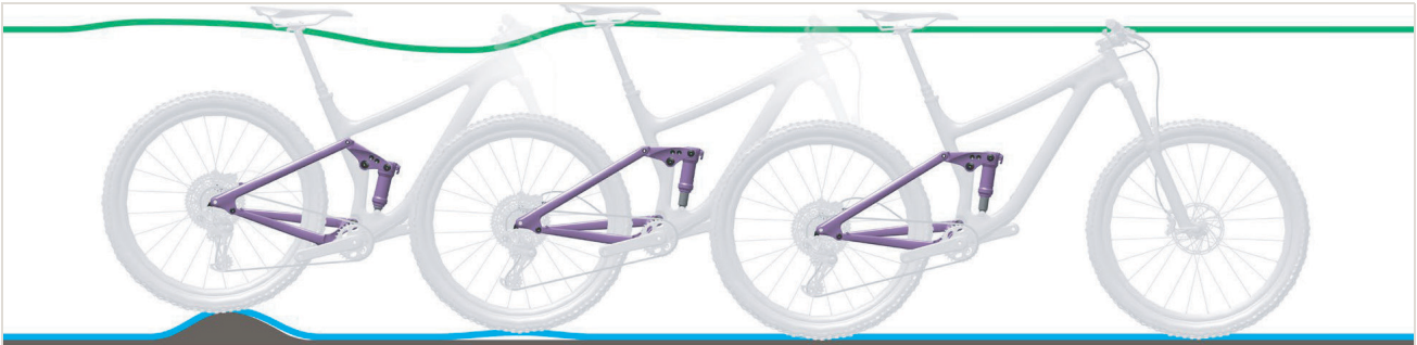
Abbildung 502: Zu schnelles Ausfedern des Hinterbau-Dämpfers
