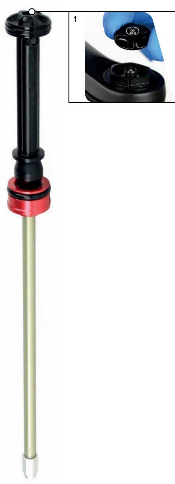
Abbildung 38: Luftventil (Gabel) der DebonAir
